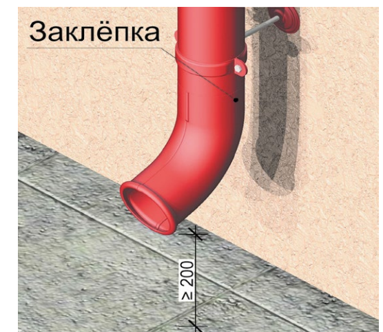
Рис. 21 Установка отвода трубы
