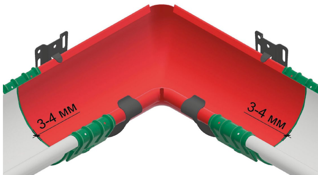
Рис. 16 Установка угловых элементов
