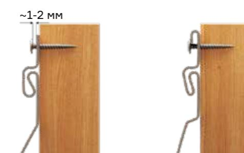
Монтаж панелей без антиураганного замка (панели серии STANDARD). "Шуршит" при сильном ветре.
