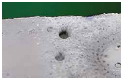
Другой сайдинг под микроскопом 200x
